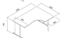
Le scrivanie possono essere unite grazie al raccordo angolare 90°. Disponibile il supporto metallico cilindrico (Ø 60 mm) come elemento opzionale per un utilizzo in totale sicurezza del raccordo angolare 90°.
